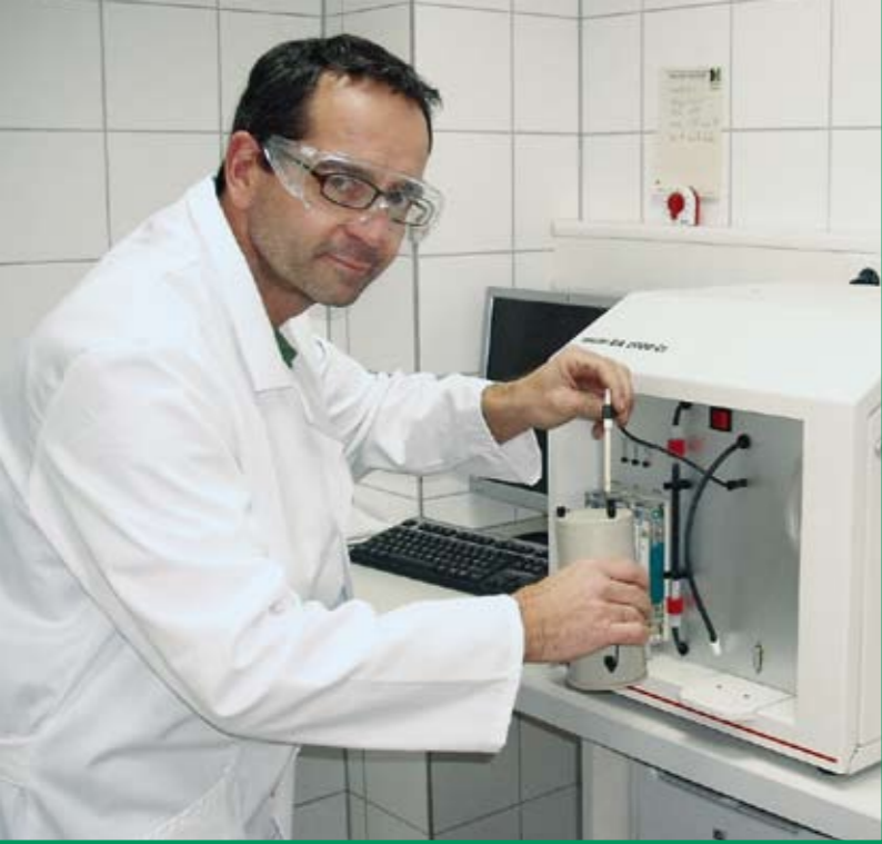
Heizwert und Chlorgehalt entscheiden über die Qualität der Ersatzbrennstoffe. Im neuen Analyselabor in Gustavsburg – auf dem Foto Dr. Rainer Köppler – werden sie nun exakt festgestellt.
