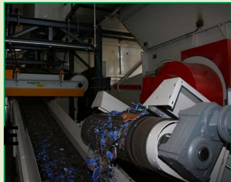
Aus groß mach klein: Nur „Schnipsel“ sind von den 240-Liter Tonnen übrig geblieben. Doch auch diese können noch zu Granulat gemahlen werden.
