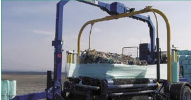
Wie eine Riesenspinne: Die Wickelmaschine verpackt die gepressten Müllballen mit einer Kunststoffolie. Anschließend gehen die Ballen auf Halde (im Hintergrund) und warten auf freie Verbrennungskapazitäten.
